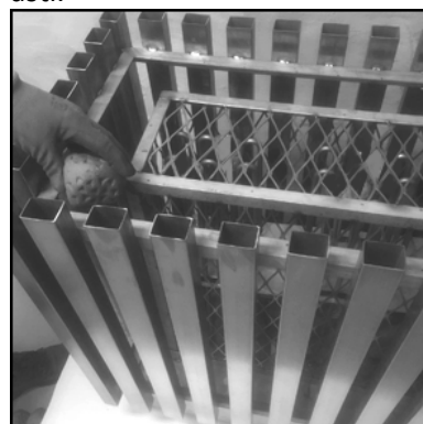
9. Kivitä sisä- ja ulkokehikon väli Kerkes Tetra iso ja pieni -kiuaskivillä. Lisää lopuksi kivet myös sisäkehikon päälle (Iso -ja pieni Tetra)
